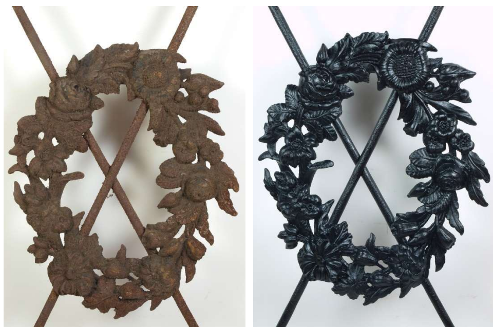
Litinová ozdoba Hoř H 5792 - detail, před a po konzervaci
